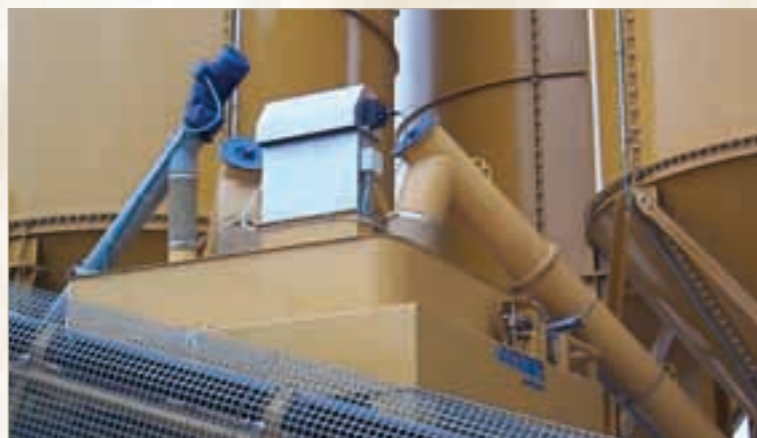
Weigh hopper loaded by silo Behälterwaage unter Silo Doseur alimenté par silo Dosatore alimentato da silo サイロより直投する場合
